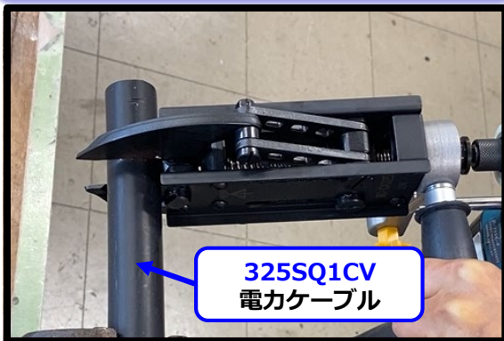
【325SQ電カケーブル切断前】
