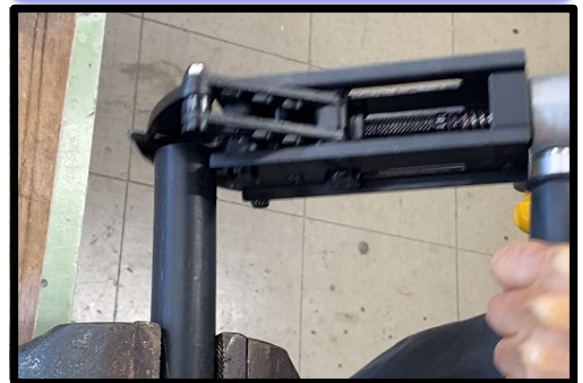
【325SQ電カケーブル切断後】
